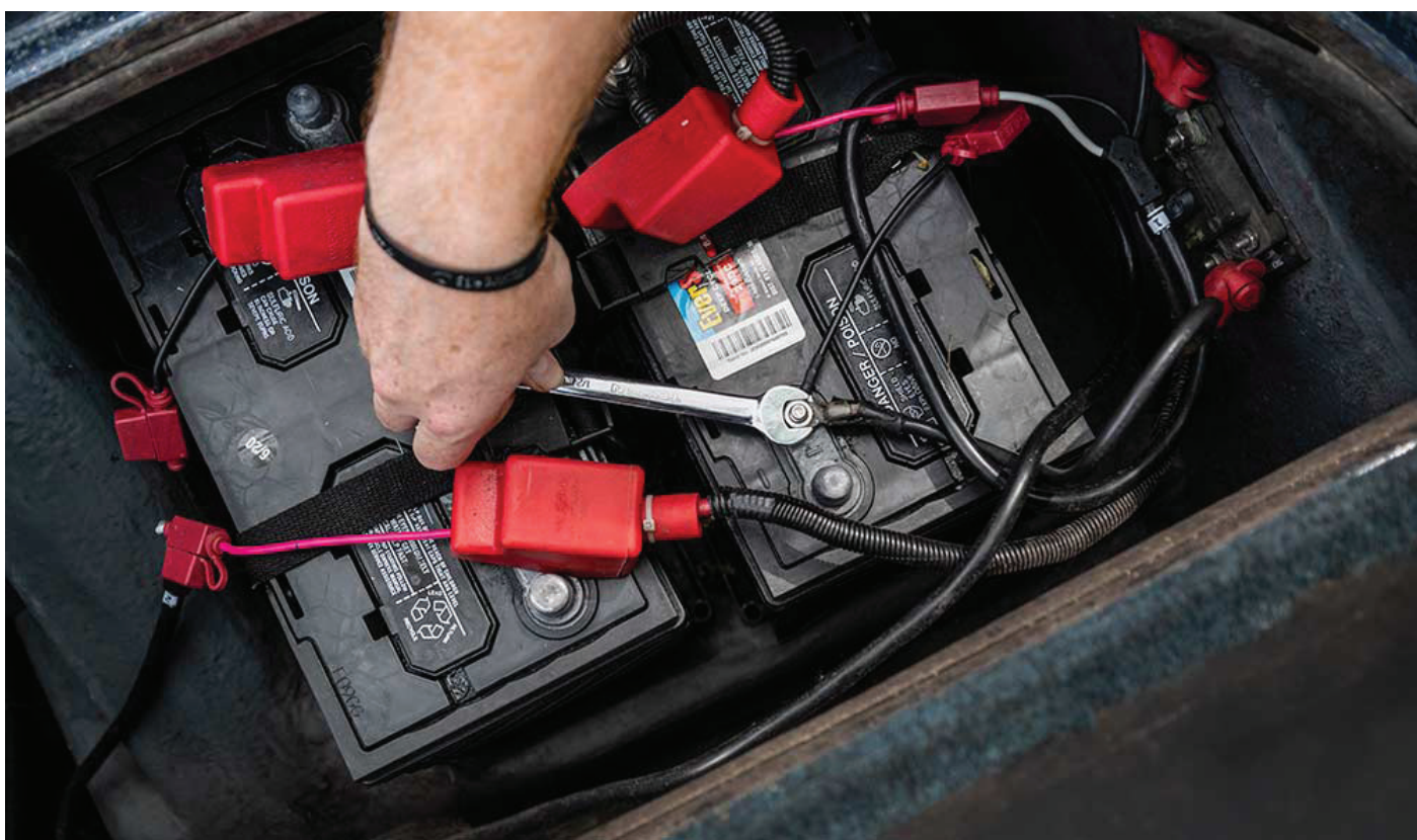
Vérification du serrage des différentes connexions.
