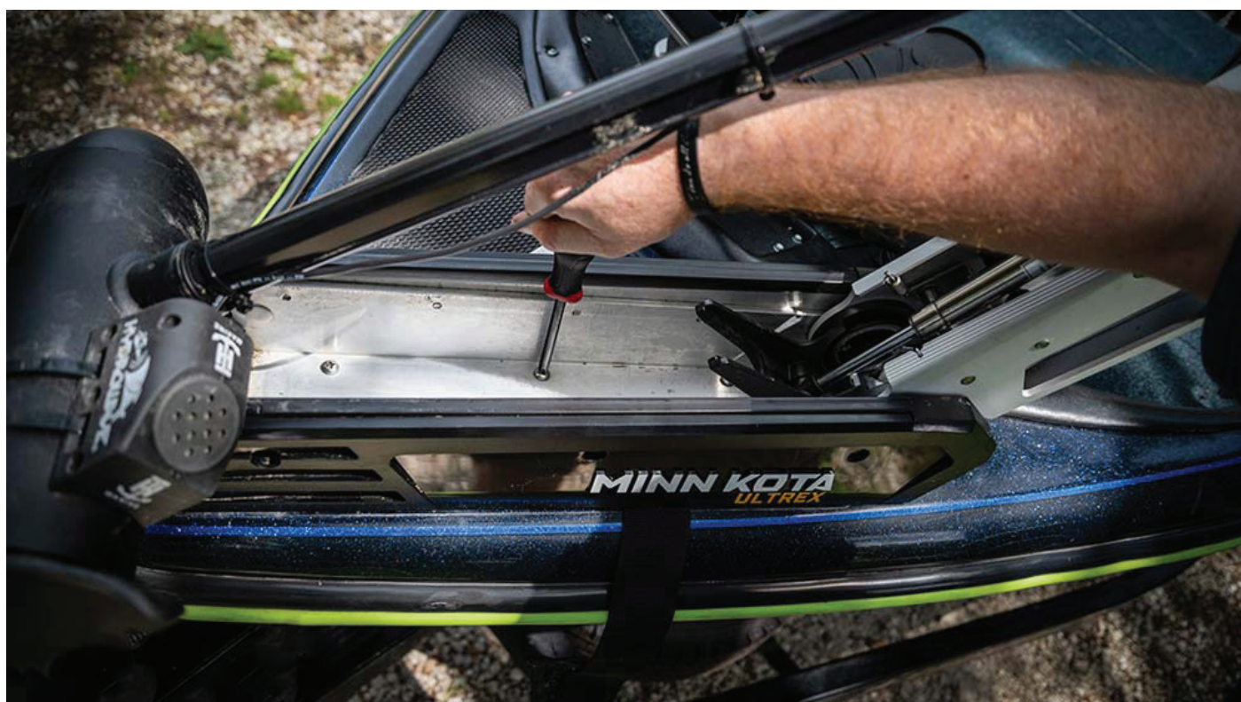
Serrage des boulons de fixation moteur
